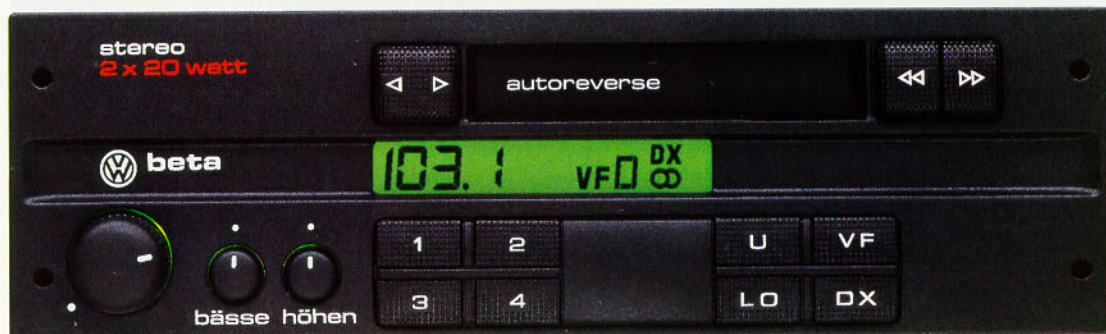
Das Radio-Cassettengerät „beta“. Mit 4 Stationstasten für je 4 UKW-VF-Sender, UKW-Stereo-Empfangsteil, Verkehrsfunktaaste, Sendersuchlauf, digitaler Flüssigkristall-Anzeige, getrennter Höhen- und Tiefenregelung, Stereo-Cassettenteil mit schnellem Vor- und Rücklauf, mechanischem Autoreverse-Cassettenlaufwerk mit Pinch-Release
