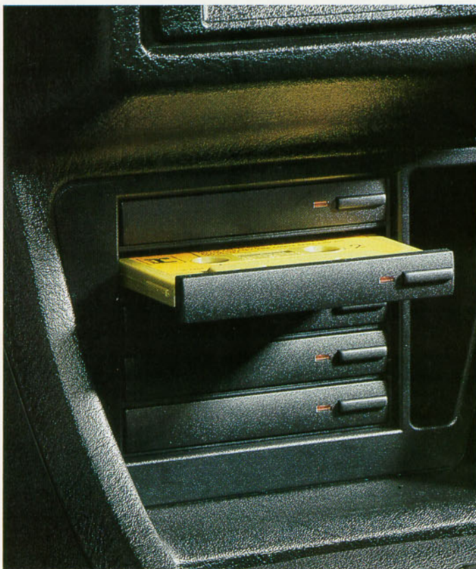
Die beleuchtete Cassettenablage. Mit optischer Belegungsanzeige und Spulenarretierung gegen Bandsalat.
