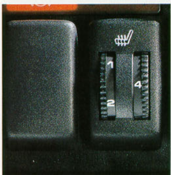
Die Sitzheizung. Spricht besonders schnell an, dadurch behagliches Sitzen, insbesondere bei Kaltstart im Winter. Für beide Vordersitze getrennt regulierbar.
